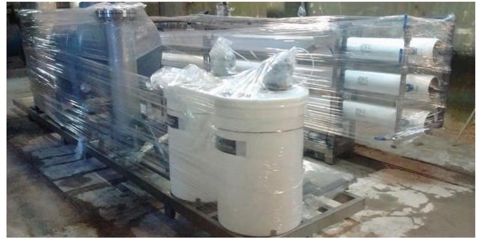
La Central recibió el equipamiento para la instalación de la nueva planta de ósmosis inversa para la generación de agua destilada para suministro de los grupos de vapor. Con esta nueva tecnología, que no utiliza ácido sulfúrico, se mejoran las condiciones de seguridad del personal y se asegura la calidad del agua.
